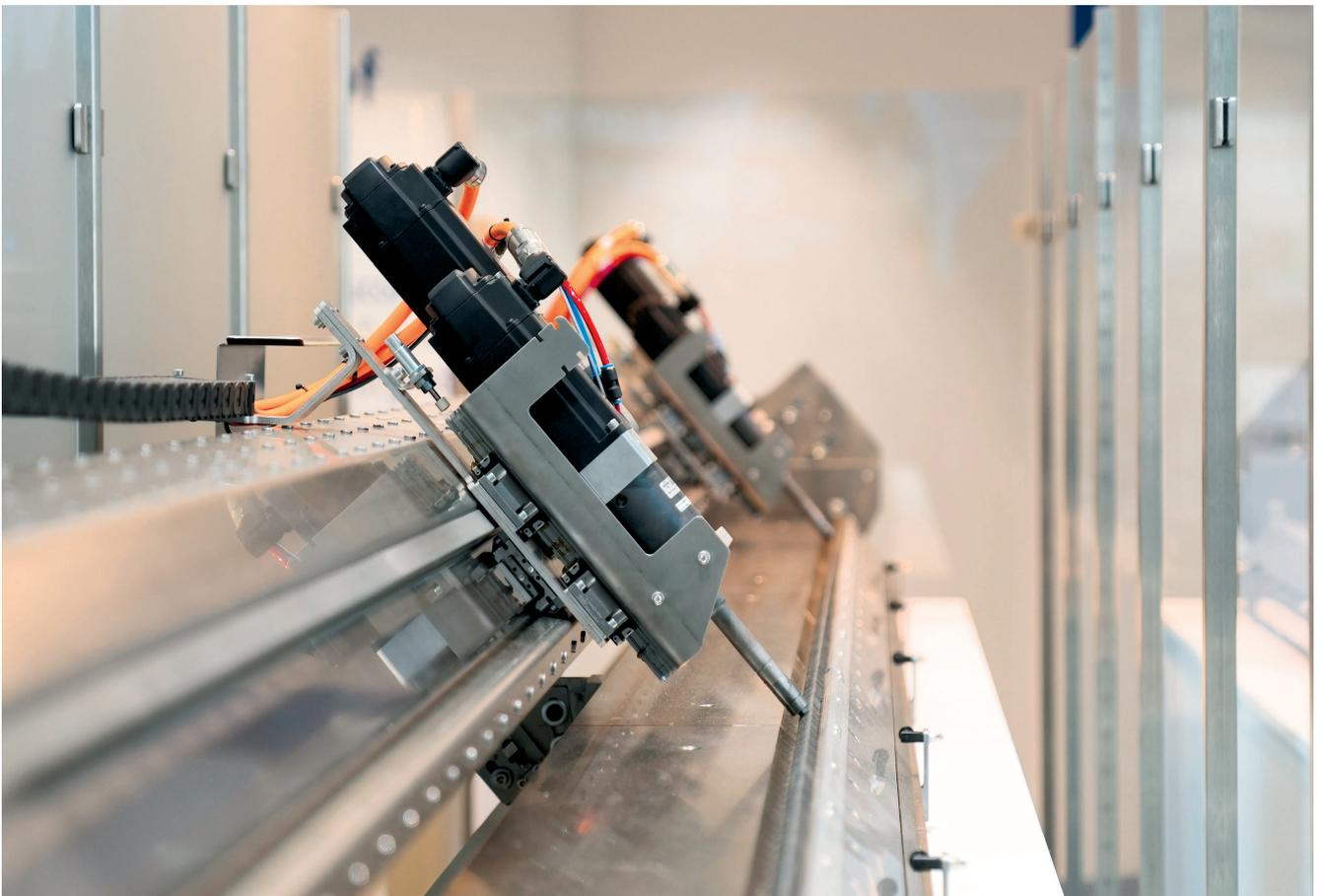
Fixe Truppe: Zwei motorisierte Schrauber fahren an der Düse entlang und justieren automatisch alle Einstellschrauben.
